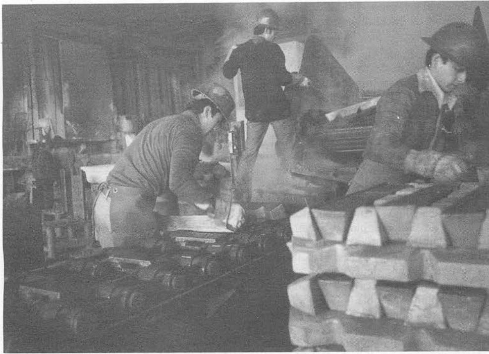
Le démoulage des lingots de cuivre dans la mine chilienne El Teniente.
