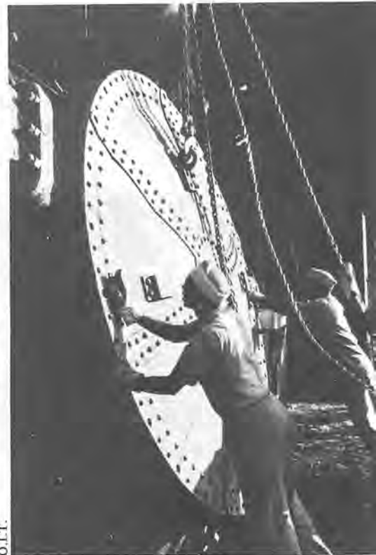
O.I.T. Ouvriers des aciéries Tata à Jamshedpour travaillant sur une pièce d'un four Bessmer.
