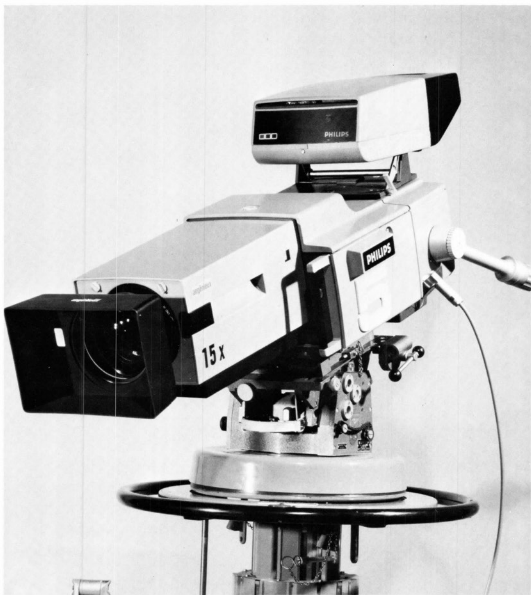
Die mit der Plumbiconröhre ausgerüstete Philips-Fernsehkamera. Diese Röhre, die für das Farbfernsehen eine gewaltige Verbesserung darstellte, wird heute weltweit eingesetzt
